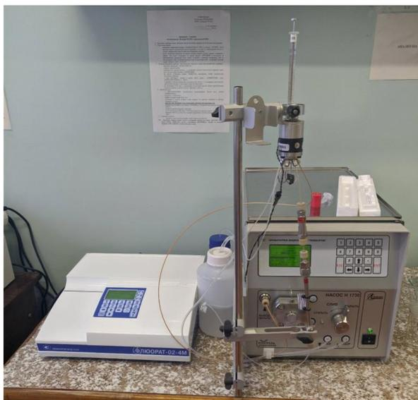
Рис. 5. Хроматограф жидкостный Люмахром в лаборатории ЦМС ФГБУ "Северное УГМС".
