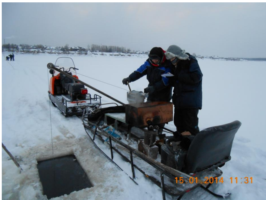
Измерение расхода воды на ГП-1 Усть-Пинега, гидрологи Т.Ю. Антонова и Б.А. Шевченко.
