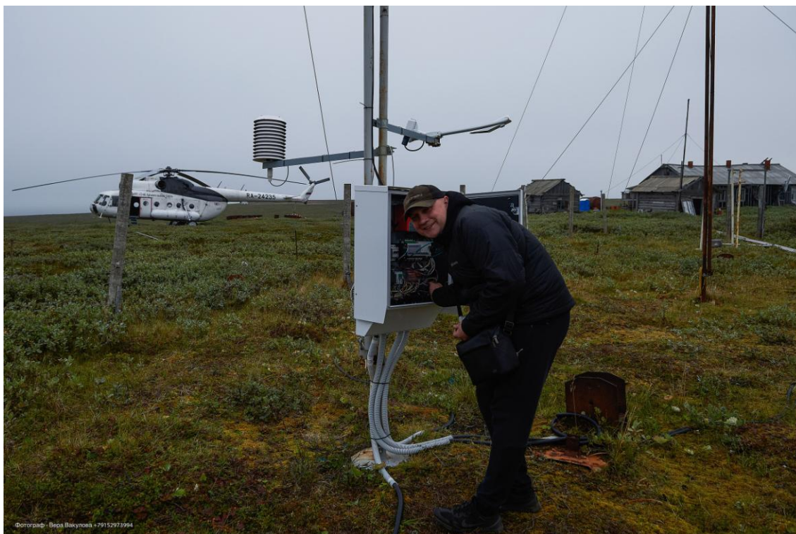
Обслуживание датчиков АМК на МГ-2 Колгуев Северный. Фото Веры Вакуловой.
