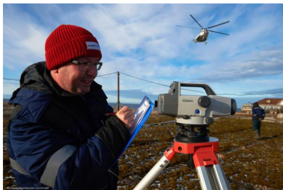
Контрольные нивелировки реперов и уровенных рек. Фото Веры Вакуловой.
