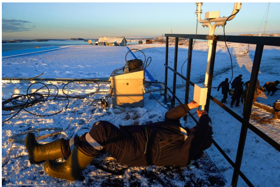
Установка новой базовой станции радиозондирования атмосферы "Полус - С". Фото - Вакулова В.С.
