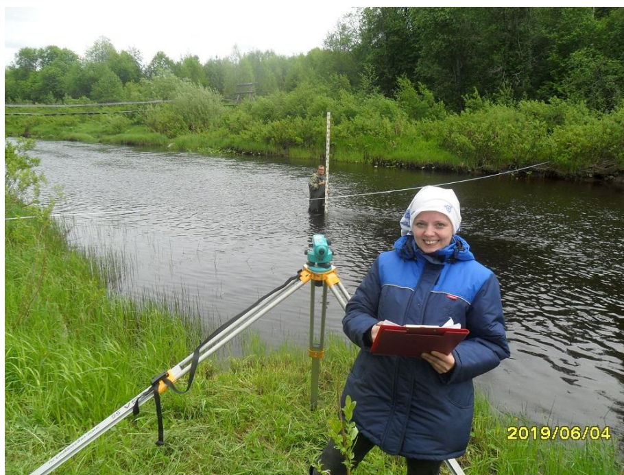
Проведение нивелировки до горизонта высоких вод специалистами Г-2 Великий Устюг. Работу выполняют техник-гидролог Мусинский С.М и гидролог Пестовникова О.В., 2019 год.
