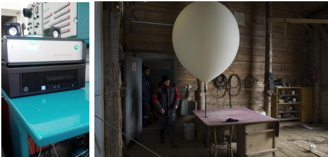
Рис. 1-2. Базовая станция системы навигационного радиозондирования «Полус-М»
