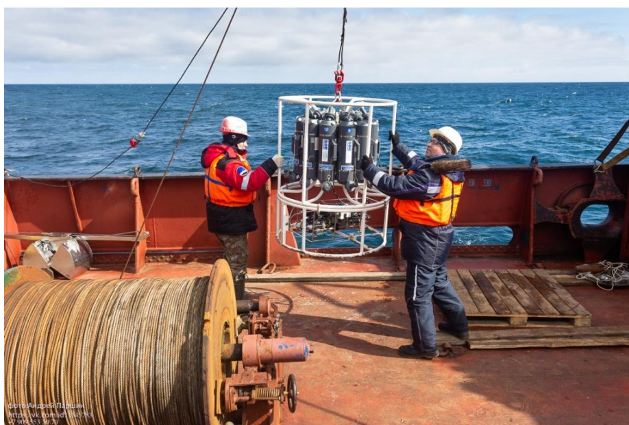
Рис. 1. Работа гидрологическим зондом и пробоотборным комплексом.
