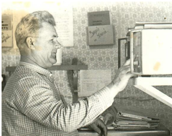
Рис. 1. Н.В. Удалов на станции измеряет по М-63-М направление и скорость ветра.
