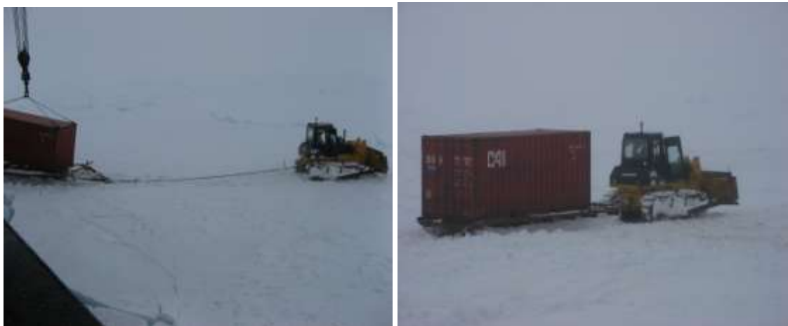
Рисунок 2 Способ выгрузки для разгрузочной площадки у трюмов 3 и 4
